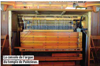
Daniel Bulloz va changer les 154 membranes qui composent la console de l'orgue de Palézieux.
